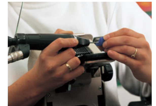
Bohren des Kanals für den Filter
