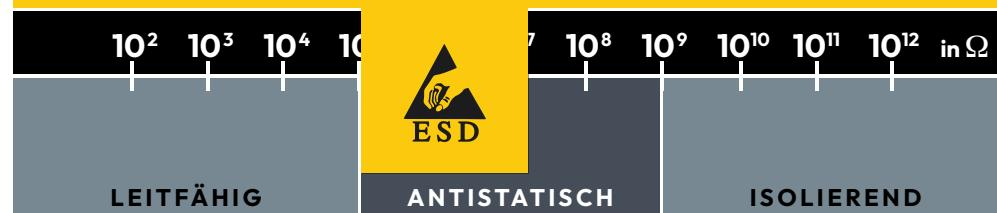
ESD-Sicherheitsschuhe müssen die Anforderungen nach DIN EN 61340-5-1 erfüllen. Das bedeutet, dass der Durchgangswiderstand des Schuhs zwischen 0,1 und 35 MΩ (Mega-Ohm) liegen muss. Hierzu bedarf es speziell entwickelter Einlegesohlen mit ESD-Technologie. ESD-Schuhe sind mit obenstehendem Logo gekennzeichnet.
